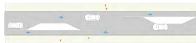
Schéma de principe : l'écluse
